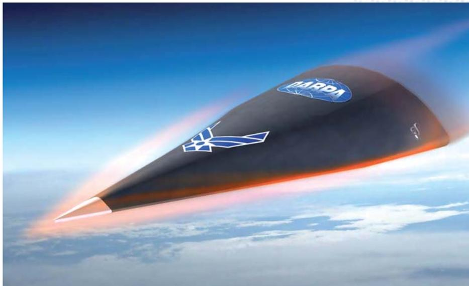
Визуализация этапа спуска гиперзвукового летательного аппарата Falcon HTV-2. Источник: Aviation Week
