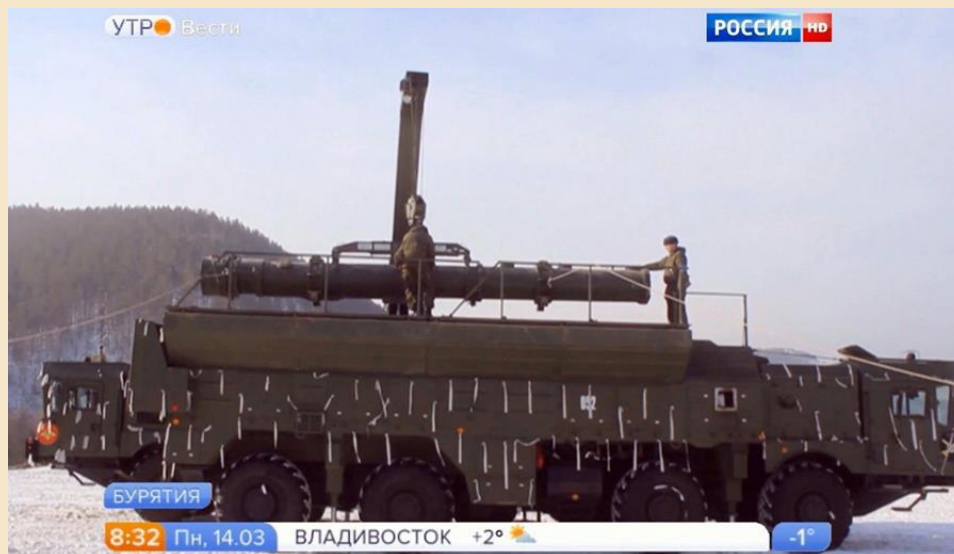
Рис. 1. Загрузка пусковой трубы в ТПУ комплекса Искандер-М . Источник: Youtube
