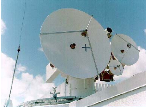
Рис. 4 Внешний вид опытного образца станции поддержания связи с перехватчиком в полете (IFICS)
