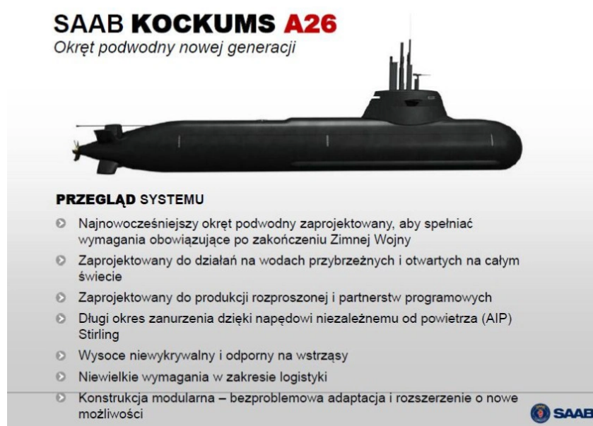
Рис. 5 Шведская подводная лодка SAAB Kockums A26, составляющая основу программы «Орка» (предназначение – выполнение боевых задач в прибрежных водах и открытых акваториях; степень автономности – увеличенная благодаря аэробному двигателю Стерлинга; степень скрытности – высокая). Источник: составлено автором на основе открытых данных.
