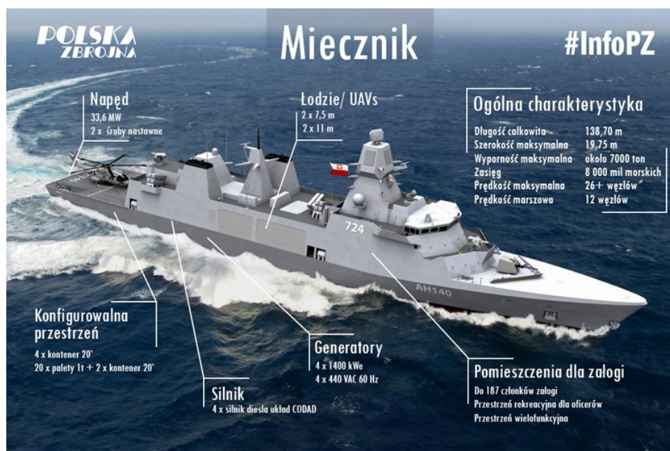
Рис. 4 Тактико-технические характеристики фрегата Miecznik (длина – 138,7 м., ширина – 19,75 м., максимальное водоизмещение – около 7 тыс. тонн, дальность плавания – 8 тыс. морских миль, максимальная скорость – более 26 узлов, крейсерская скорость – 12 узлов). Источник: составлено автором на основе открытых данных.
